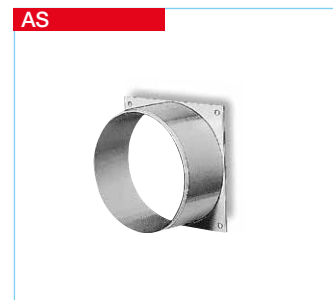
AS Anschluss-Stutzen AS Mit quadratischer Flanschplatte (102 x 102 mm) und rundem Stutzen (50 mm lang), aus Kunststoff. Zum Aufsetzen von Rohren (ND 100) auf plane Flächen.
