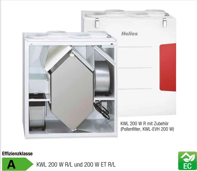
**Kompaktgeräte mit Wärmerückgewinnung für die zentrale Be- und Entlüftung von Wohnhäusern und Etagenwohnungen. Perfekt vorbereitet für moderne Kommunikation und Bedienung mit der neuen Helios easyControls 3.0 Steuerung inkl. integrierter Netzwerkanbindung. Ausgestattet mit EC-Ventilatoren für geringen Energieverbrauch und hocheffizientem Kunststoff- oder wahlweise Enthalpie-Wärmetauscher für zusätzliche Feuchterückgewinnung.**
